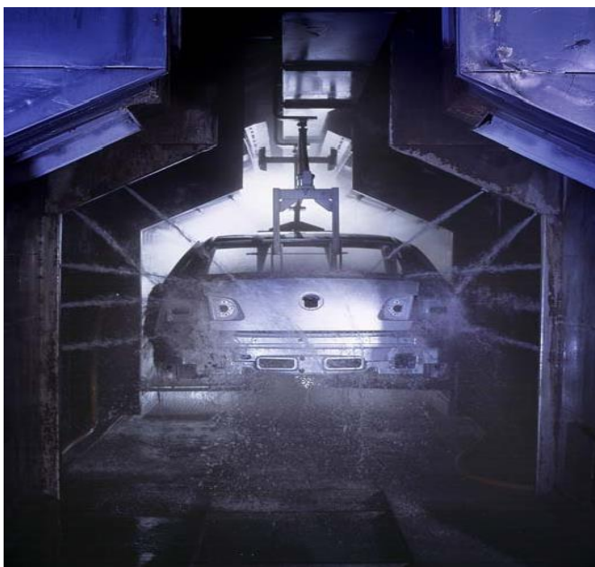
Instalatie de decapare acida
